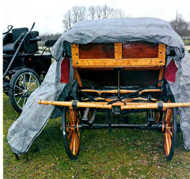
Die Schutzhaube lässt sich mit zwei Besen (linkes Bild) ganz einfach über größere Fahrzeuge stülpen. Zwei Gurtbänder mit Schlaufe unterstützen beim Ziehen. Außerdem kann mit ihnen die Haube am Fahrzeug fixiert werden (rechtes Bild). Fotos: Thomas Sagkob
